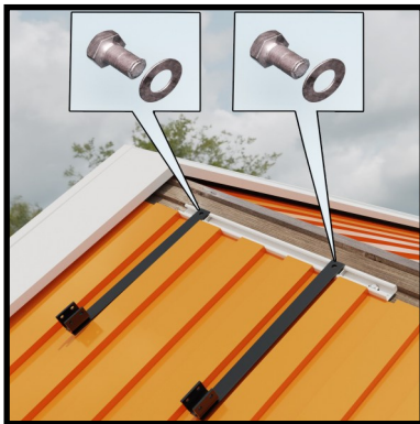
5. Fest fast øvre festestag 2 . Bruk bolt 7 , skive 11 og mutter 9 .
